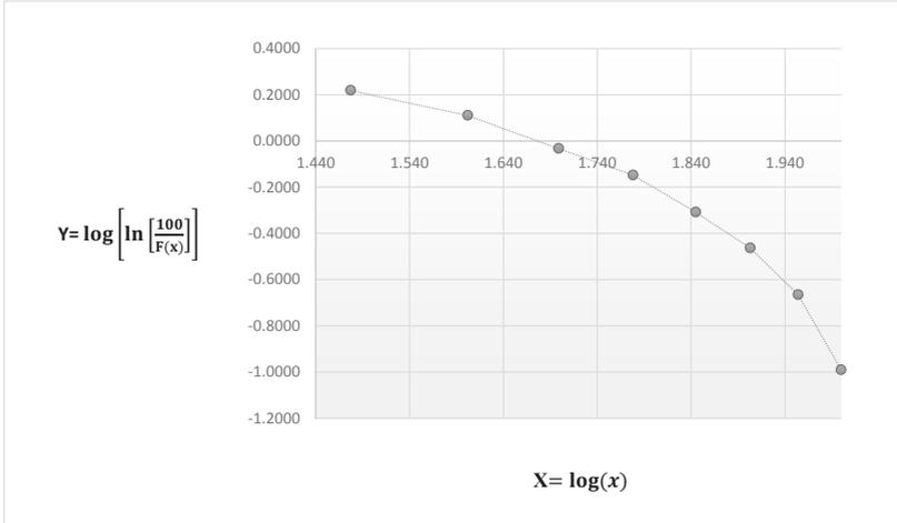
Figura 8. Gráfico de Análisis Granulométrico del Equipo A, según el modelo RR.
