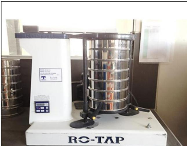
Figura 4. Equipo tamizador automático Ro-Tap y tamices. Tomado de “Evaluación de la influencia de las variables en la distribución granulométrica del producto de molienda por bolas de minerales mediante diseños experimentales”, Zumarán Ferrofin, Diego Martín, 2017, p. 29. Recuperado de <http://repositorio.unsa.edu.pe/bitstream/handle/UNSA/3214/IMzufedm.pdf?sequence=1&isAllowed=y>
