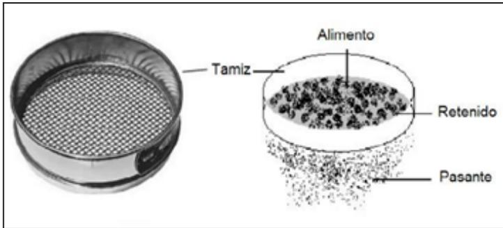
Figura 3. Tamices y proceso de tamizado. Tomado de “Evaluación de la influencia de las variables en la distribución granulométrica del producto de molienda por bolas de minerales mediante diseños experimentales”, Zumarán Ferrofin, Diego Martín, 2017, p. 24. Recuperado de <http://repositorio.unsa.edu.pe/bitstream/handle/UNSA/3214/IMzufedm.pdf?sequence=1&isAllowed=y>
