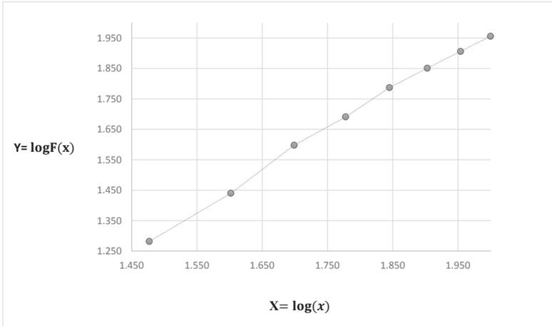
Figura 7. Gráfico de Análisis Granulométrico del Equipo A, según el modelo GGS.
